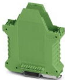
Tragschienengehäuse, Gehäuseunterteil mit Metallfußriegel, hohe Bauform, ohne Lüftungsschlitze, Breite: 22,6 mm, Höhe: 99 mm, Tiefe: 107,3 mm, Querverbindung: integrierter Busverbinder, Polzahl Querverbinder: 10, Farbe: grün (6021)
