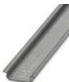
Tragschiene ungelocht, Standardprofil, Breite: 35 mm, Höhe: 7,5 mm, nach EN 60715, Material: Edelstahl V2A, unbeschichtet, Länge: 2000 mm, Farbe: silberfarben
