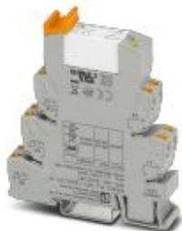
PLC-INTERFACE, bestehend aus Grundklemme PLC-BPT.../21-21 mit Push-in-Anschluss und steckbarem Miniaturrelais mit Mehrlagen-Goldkontakt, zur Montage auf Tragschiene NS 35/7,5, 2 Wechsler, Eingangsspannung 120 V AC/DC
