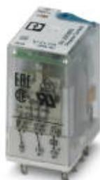
Steckbare Industrirelais mit Leistungskontakten, 2 Wechsler, Prüftaste, Status-LED, Freilaufdiode, mechanische Schaltstellungsanzeige, Polarität A1+, A2-, Eingangsspannung: 110 V DC
