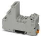
Relaissockel RIF-2..., für Industrirelais mit 2- oder 4-Wechslern, Schraubanschluss, Steckmöglichkeit für Eingangs-/Entstörmodule, zur Montage auf NS 35/7,5
