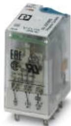
Steckbare Industrirelais mit Leistungskontakten, 2 Wechsler, Prüftaste, Status-LED, Freilaufdiode, mechanische Schaltstellungsanzeige, Polarität A1+, A2-, Eingangsspannung: 220 V DC
