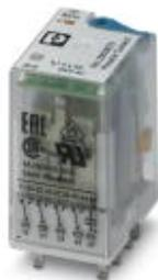
Steckbare Industrirelais mit Leistungskontakten und zusätzlicher Hartvergoldung, 4 Wechsler, Prüftaste, Status-LED, Freilaufdiode, mechanische Schaltstellungsanzeige, Polarität A1+, A2-, Spulenspannung: 60 V DC
