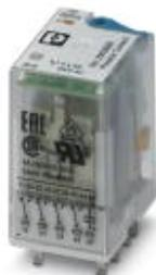
Steckbare Industrirelais mit Leistungskontakten, 4 Wechsler, Prüftaste, Status-LED, Freilaufdiode, mechanische Schaltstellungsanzeige, Polarität A1+, A2-, Spulenspannung: 220 V DC
