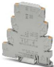
Klemme zur Filterung von Testpulsen sicherer Halbleiterausgänge mit einstellbaren Filterwerten (20  $\mu$ F/86  $\mu$ F), sowie zur EMV Filterung von 24 V-Signalen bis zu einer Stromstärke von 2 A.
