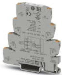
Analoges Eingangsmodul für PLC logic Logikmodule (nur Generation 2), einkanalig, Signaltyp (4 ... 20 mA, 0 ... 20 mA, 0 ... 10 V, 2 ... 10 V) über DIP-Schalter konfigurierbar, Push-in-Anschluss
