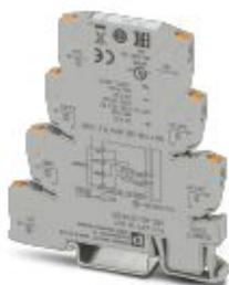
Analoges Ausgangsmodul für PLC logic Logikmodule (nur Generation 2), einkanalig, Signaltyp (4 ... 20 mA, 0 ... 20 mA, 0 ... 10 V, 2 ... 10 V) über DIP-Schalter konfigurierbar, Push-in-Anschluss
