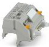
V8-Adapter für 8 x PLC-INTERFACE (6,2 mm), Steuerung: SPS-Systemverkabelung von Ausgangskarten, Anschluss 1: Schraubanschluss 1x, Anschluss 2: IDC/FLK-Stiftleiste 1x 14-polig, Anschluss 3: Steckanschluss (Aufrautbar auf 8x PLC-INTERFACE-Klemmen), Anzahl der Kanäle: 8, Ansteuerlogik: plusschaltend
