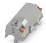
V8-Adapter für 8 x PLC-INTERFACE (14 mm), Steuerung: SPS-Systemverkabelung von Ausgangskarten, Anschluss 1: Schraubanschluss 1x, Anschluss 2: IDC/FLK-Stiftleiste 1x 14-polig, Anschluss 3: Steckanschluss (Aufrautbar auf 8x PLC-INTERFACE-Klemmen), Anzahl der Kanäle: 8, Ansteuerlogik: plusschaltend
