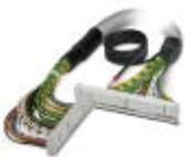
Konfektioniertes, geschirmtes Rundkabel; Anschluss 1: IDC/FLK-Buchsenleiste (1x 50-polig); Anschluss 2: IDC/FLK-Buchsenleiste (1x 50-polig) (Das Schirmgeflecht ist auf ein separates Kabelende herausgeführt.); Kabellänge: 1 m
