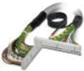
Konfektioniertes, geschirmtes Rundkabel; Anschluss 1: IDC/FLK-Buchsenleiste (1x 50-polig); Anschluss 2: IDC/FLK-Buchsenleiste (1x 50-polig) (Das Schirmgeflecht ist auf ein separates Kabelende herausgeführt.); Kabellänge: 3 m
