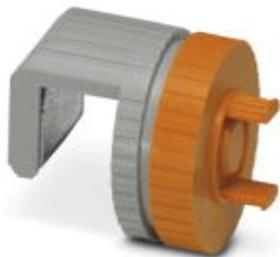
Die optionale Haltevorrichtung bietet der Rogowski-Spule sicheren Sitz auf Stromschienen mit einer Stärke von 5 ... 10 mm. Bei der Installation wird das Spulengehäuse auf den Flansch der Haltevorrichtung geschoben und verrastet automatisch.
