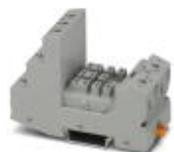
Relaissockel RIF-4..., für Hochleistungsrelais mit 2 oder 3 Wechslern oder 3 Schließern, Schraubanschluss, Steckmöglichkeit für Eingangs-/Entstörmodule, zur Montage auf NS 35/7,5
