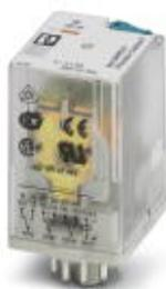
Steckbare Oktalrelais mit Leistungskontakten, 3 Wechsler, Prüftaste, Freilaufdiode, mechanische Schaltstellungsanzeige, Polarität A1+, A2-, Eingangsspannung: 12 V DC
