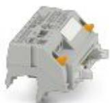
V8-Adapter für 8 x PLC-INTERFACE (6,2 mm), Steuerung: SPS-Systemverkabelung von Ausgangskarten, Anschluss 1: Schraubanschluss 1x, Anschluss 2: IDC/FLK-Stiftleiste 1x 14-polig, Anschluss 3: Steckanschluss (Aufrastbar auf 8x PLC-INTERFACE-Klemmen), Anzahl der Kanäle: 8, Ansteuerlogik: minusschaltend
