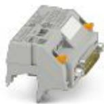
V8-Adapter für 8 x PLC-INTERFACE (6,2 mm), Steuerung: SPS-Systemverkabelung von Ausgangskarten, Anschluss 1: Schraubanschluss 1x, Anschluss 2: D-SUB-Stiftleiste 1x 15-polig, Anschluss 3: Steckanschluss (Aufrastbar auf 8x PLC-INTERFACE-Klemmen), Anzahl der Kanäle: 8, Ansteuerlogik: plusschaltend
