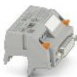
V8-Adapter für 8 x PLC-INTERFACE (6,2 mm), Steuerung: SPS-Systemverkabelung von Ausgangskarten, Anschluss 1: Schraubanschluss 1x, Anschluss 2: D-SUB-Buchsenleiste 1x 15-polig, Anschluss 3: Steckanschluss (Aufrastbar auf 8x PLC-INTERFACE-Klemmen), Anzahl der Kanäle: 8, Ansteuerlogik: plusschaltend
