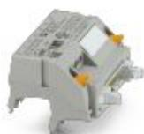
V8-Adapter für 8 x PLC-INTERFACE (6,2 mm), Steuerung: SPS-Systemverkabelung von Ausgangskarten, Anschluss 1: Schraubanschluss 1x, Anschluss 2: IDC/FLK-Stiftleiste 1x 14-polig, Anschluss 3: Steckanschluss (Aufrastbar auf 8x PLC-INTERFACE-Klemmen), Anzahl der Kanäle: 8, Ansteuerlogik: plusschaltend
