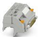
V8-Adapter für 8 x PLC-INTERFACE (6,2 mm), Steuerung: SPS-Systemverkabelung von Ausgangskarten, Anschluss 1: Schraubanschluss 1x, Anschluss 2: D-SUB-Stiftleiste 1x 15-polig, Anschluss 3: Steckanschluss (Aufrastbar auf 8x PLC-INTERFACE-Klemmen), Anzahl der Kanäle: 8, Ansteuerlogik: plusschaltend
