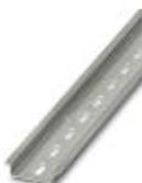
Tragschiene gelocht, Standardprofil, Breite: 35 mm, Höhe: 7,5 mm, nach EN 60715, Material: Stahl, verzinkt, dickschichtpassiviert, Länge: 2000 mm, Farbe: silber
