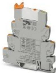
PLC-INTERFACE, bestehend aus Grundklemme PLC-BPT.../21 mit Push-in-Anschluss und steckbarem Miniaturrelais mit Leistungskontakt und Handbetätigung, 1 Wechsler, Eingangsspannung 24 V DC
