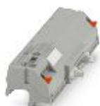
V8-Adapter für 8 x PLC-INTERFACE (14 mm), Steuerung: SPS-Systemverkabelung von Ausgangskarten, Anschluss 1: Schraubanschluss 1x, Anschluss 2: IDC/FLK-Stiftleiste 1x 14-polig, Anschluss 3: Steckanschluss (Aufrastbar auf 8x PLC-INTERFACE-Klemmen), Anzahl der Kanäle: 8, Ansteuerlogik: plusschaltend
