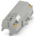
V8-Adapter für 8 x PLC-INTERFACE (14 mm), Steuerung: SPS-Systemverkabelung von Ausgangskarten, Anschluss 1: Schraubanschluss 1x, Anschluss 2: IDC/FLK-Stiftleiste 1x 14-polig, Anschluss 3: Steckanschluss (Aufraufbar auf 8x PLC-INTERFACE-Klemmen), Anzahl der Kanäle: 8, Ansteuerlogik: minusschaltend
