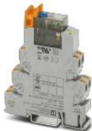
PLC-INTERFACE, bestehend aus Relaissockel und steckbarem Leistungskontaktrelais mit Handbetätigung, integrierter Status-LED und Freilaufdiode, Push-in-Anschluss, 2 Wechsler, Eingangsspannung: 24 V DC
