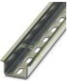
Tragschiene gelocht, Standardprofil, Breite: 35 mm, Höhe: 15 mm, ähnlich EN 60715, Material: Stahl, verzinkt, dickschichtpassiviert, Länge: 2000 mm, Farbe: silberfarben
