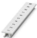
Zackband, Streifen, weiß, beschriftet, beschriftbar mit: CMS-P1-PLOTTER, längs bedruckt: fortlaufende Zahlen 1 ... 10, 11 ... 20 usw. bis 491 ... 500, Montageart: verrasten in hoher Schildchennut, für Klemmenbreite: 6,2 mm, Schriftfeldgröße: 6,15 x 10,5 mm, Anzahl der Einzelschilder: 10
