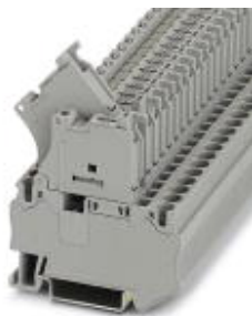
Hebelsicherungsklemme, Farbe grau, für 5 x 20 mm G-Sicherungseinsätze, mit LED für 24 V DC
