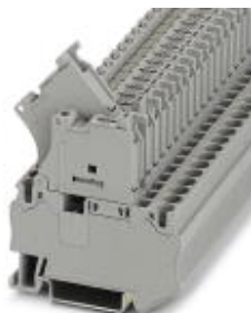
Pojistková svornice s pákovým ovládáním, barva šedá, pro pojistkové vložky G 5 x 20 mm, s LED indikací pro 24 V DC
