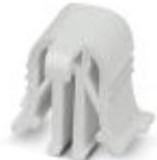
Schaltsperre, zur zusätzliche Verriegelung der Kurzschluss-Schaltelemente in Stromwandler-Messkreisen, Länge: 16,3 mm, Breite: 12,5 mm, Höhe: 13,6 mm, Farbe: weiß
