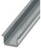
Tragschiene ungelocht, Standardprofil, Breite: 35 mm, Höhe: 15 mm, ähnlich EN 60715, Material: Stahl, verzinkt, Länge: 2000 mm, Farbe: silberfarben
