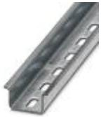
Tragschiene gelocht, Standardprofil, Breite: 35 mm, Höhe: 15 mm, ähnlich EN 60715, Material: Stahl, verzinkt, Länge: 2000 mm, Farbe: silberfarben
