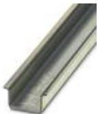
Tragschiene ungelocht, Standardprofil, Breite: 35 mm, Höhe: 15 mm, ähnlich EN 60715, Material: Stahl, verzinkt, dickschichtpassiviert, Länge: 2000 mm, Farbe: silberfarben
