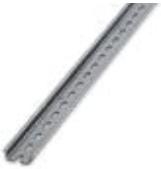
Tragschiene gelocht, Standardprofil, Breite: 35 mm, Höhe: 7,5 mm, nach EN 60715, Material: Stahl, verzinkt, weiß-passiviert, Länge: 2000 mm, Farbe: silberfarben
