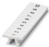
Zackband, Streifen, weiß, beschriftet, längs bedruckt: fortlaufende Zahlen, 1 ... 10, 11 ... 20 usw. bis 91 ... 100, Montageart: verrasten in hoher Schildchennut, für Klemmenbreite: 3,5 mm, Schriftfeldgröße: 3,5 x 10,5 mm, Anzahl der Einzelschilder: 10
