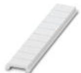
Zackband flach, Streifen, weiß, unbeschriftet, beschriftbar mit: PLOTMARK, CMS-P1-PLOTTER, Montageart: verrasten in flacher Schildchennut, für Klemmenbreite: 3,5 mm, Schriftfeldgröße: 3,5 x 5,2 mm, Anzahl der Einzelschilder: 10
