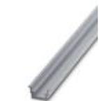
Tragschiene ungelocht, Standardprofil, Breite: 35 mm, Höhe: 15 mm, ähnlich EN 60715, Material: Aluminium, unbeschichtet, Länge: 2000 mm, Farbe: silberfarben
