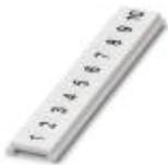
Zackband flach, Streifen, weiß, beschriftet, längs bedruckt: fortlaufende Zahlen 1 ... 10, 11 ... 20 usw. bis 91 ... 100, Montageart: verrasten in flacher Schildchennut, für Klemmenbreite: 3,5 mm, Schriftfeldgröße: 5,15 x 3,5 mm, Anzahl der Einzelschilder: 10
