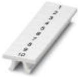
Zackband, Streifen, weiß, beschriftet, quer bedruckt: fortlaufende Zahlen 1 ... 10, 11 ... 20 usw. bis 91 ... 100, Montageart: verrasten in hoher Schildchennut, für Klemmenbreite: 3,5 mm, Schriftfeldgröße: 3,5 x 10,5 mm, Anzahl der Einzelschilder: 10
