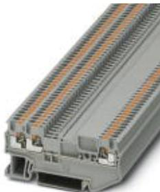
Durchgangsklemme, konturgleich zur Trennklemme, Nennspannung: 400 V, Nennstrom: 17,5 A, Anschlussart: Push-in-Anschluss, Anzahl der Anschlüsse: 3, Querschnitt: 0,14 mm<sup>2</sup> - 1,5 mm<sup>2</sup>, AWG: 26 - 14, Breite: 3,5 mm, Höhe: 30,5 mm, Farbe: grau, Montageart: NS 35/7,5, NS 35/15
