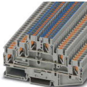
Vícepatrová svornice, typ připojení: Svorky Push-in, průřez: 0,14 mm 2 - 4 mm 2 , AWG: 26 - 12, šířka: 5,2 mm, barva: šedá, způsob montáže: NS 35/7,5, NS 35/15
