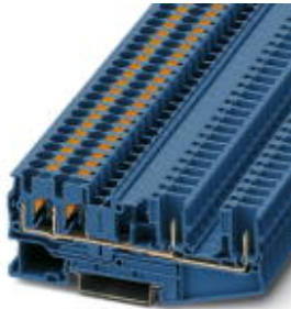
Průchozí svornice, typ připojení: Připojení Push-in / Zástrčka, průřez: 0,2 mm 2 - 6 mm 2 , AWG: 24 - 12, šířka: 6,2 mm, barva: modrá, montáž: NS 35/7,5, NS 35/15
