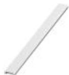
Zackband flach, Streifen, weiß, unbeschriftet, beschriftbar mit: PLOTMARK, CMS-P1-PLOTTER, Montageart: verrasten in flacher Schildchennut, für Klemmenbreite: 8 mm, Schriftfeldgröße: 5,15 x 8,15 mm, Anzahl der Einzelschilder: 10
