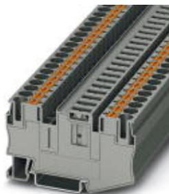
Trennklemme, Nennspannung: 500 V, Nennstrom: 20 A, Anschlussart: Push-in-Anschluss, Querschnitt: 0,5 mm<sup>2</sup> - 10 mm<sup>2</sup>, AWG: 20 - 8, Länge: 74,1 mm, Breite: 8,2 mm, Farbe: grau, Montage: NS 35/7,5, NS 35/15
