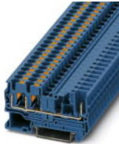
Průchozí svornice, typ připojení: Připojení Push-in / Zástrčka, průřez: 0,2 mm 2 - 6 mm 2 , AWG: 24 - 12, šířka: 6,2 mm, barva: modrá, montáž: NS 35/7,5, NS 35/15
