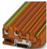
Initiatoren-/Aktorenklemme, Einspeiseklemme mit Schutzleiterfunktion, Nennspannung: 250 V, Nennstrom: 20 A, Anschlussart: Push-in-Anschluss, Anzahl der Anschlüsse: 3, Querschnitt: 0,2 mm<sup>2</sup> - 4 mm<sup>2</sup>, AWG: 24 - 12, Breite: 7 mm, Farbe: orange, Montageart: NS 35/7,5, NS 35/15
