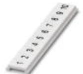
Zackband flach, Streifen, weiß, beschriftet, längs bedruckt: fortlaufende Zahlen 1 ... 10, 11 ... 20 usw. bis 91 ... 100, Montageart: verrasten in flacher Schildchennut, für Klemmenbreite: 3,5 mm, Schriftfeldgröße: 5,15 x 3,5 mm, Anzahl der Einzelschilder: 10
