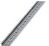
Tragschiene gelocht, Standardprofil, Breite: 35 mm, Höhe: 7,5 mm, nach EN 60715, Material: Stahl, verzinkt, weiß-passiviert, Länge: 2000 mm, Farbe: silberfarben
