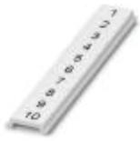
Zackband flach, Streifen, weiß, beschriftet, quer bedruckt: fortlaufende Zahlen 1 ... 10, 11 ... 20 usw. bis 91 ... 100, Montageart: verrasten in flacher Schildchennut, für Klemmenbreite: 3,5 mm, Schriftfeldgröße: 5,15 x 3,5 mm, Anzahl der Einzelschilder: 10
