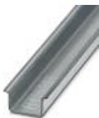
Tragschiene ungelocht, Standardprofil, Breite: 35 mm, Höhe: 15 mm, ähnlich EN 60715, Material: Stahl, verzinkt, Länge: 2000 mm, Farbe: silberfarben
