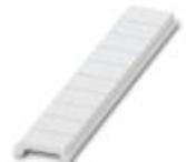
Zackband flach, Streifen, weiß, unbeschriftet, beschriftbar mit: PLOTMARK, CMS-P1-PLOTTER, Montageart: verrasten in flacher Schildchennut, für Klemmenbreite: 3,5 mm, Schriftfeldgröße: 3,5 x 5,2 mm, Anzahl der Einzelschilder: 10
