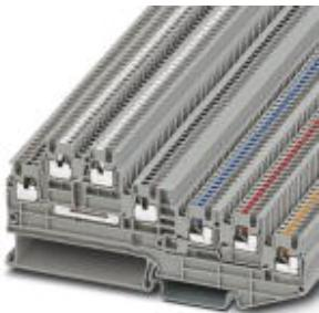
Initiatoren-/Aktorenklemme, Nennspannung: 250 V, Nennstrom: 13,5 A, Anschlussart: Push-in-Anschluss, Anzahl der Anschlüsse: 5, Querschnitt: 0,14 mm<sup>2</sup> - 1,5 mm<sup>2</sup>, AWG: 26 - 14, Breite: 3,5 mm, Höhe: 44,6 mm, Farbe: grau, Montageart: NS 35/7,5, NS 35/15
