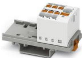
Verteilerblock, Block mit senkrechter Ausrichtung und integrierter Einspeisung. Die Blöcke sind untereinander über den Leiterschacht brückbar. Passende Steckbrücken siehe Zubehör, Nennspannung: 690 V, Nennstrom: 24 A, Anschlussart: Push-in-Anschluss, Push-in-Anschluss, Anzahl der Anschlüsse: 7, Querschnitt: 0,14 mm<sup>2</sup> - 4 mm<sup>2</sup>, AWG: 26 - 12, Breite: 28,6 mm, Farbe: weiß, Montageart: NS 35/7,5, NS 35/15
