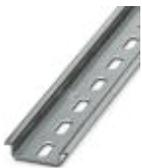
Tragschiene gelocht, Standardprofil, Breite: 35 mm, Höhe: 7,5 mm, nach EN 60715, Material: Stahl, verzinkt, Länge: 2000 mm, Farbe: silberfarben
