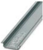
Tragschiene ungelocht, Standardprofil, Breite: 35 mm, Höhe: 7,5 mm, nach EN 60715, Material: Stahl, verzinkt, weißpassiviert, Länge: 2000 mm, Farbe: silberfarben
