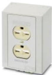
Tragschienenmontierbare Doppelsteckdose mit zwei 250 V AC/15 A-Buchsen zur Montage an einer 35 mm-Tragschiene gemäß EN 60715. Für erhöhte Sicherheit befindet sich der Erdungsstift an der Oberseite, um Kurzschlüsse zwischen den spannungsführenden und spannungsfreien Zungen zu vermeiden.
