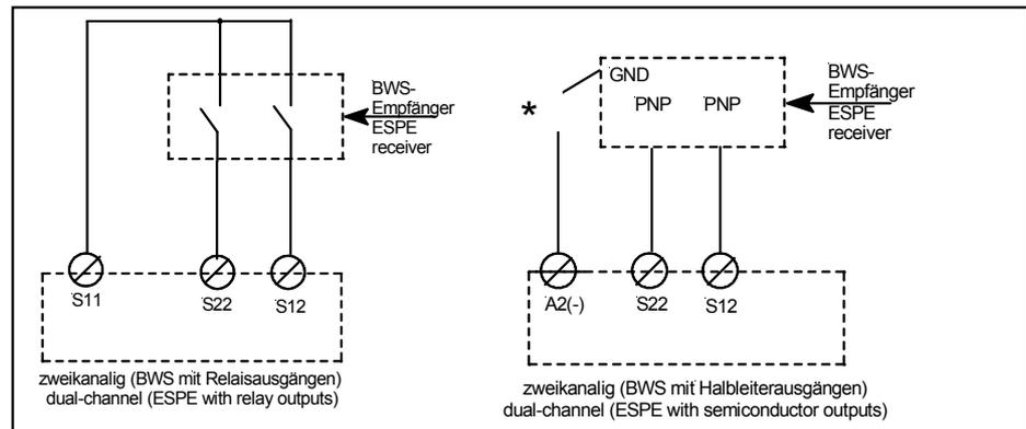
\* Wir empfehlen, die Lichtschranke und das Sicherheitsrelais aus dem gleichen Netz zu speisen. Sollte dies nicht möglich sein und müssen die Geräte aus galvanisch getrennten Netzen versorgt werden, so muss eine Brücke zwischen GND und der BWS und A2 (-) des Sicherheitsrelais gelegt werden. (ACHTUNG: Brücke nur bei galvanisch getrennten Netzen.)
