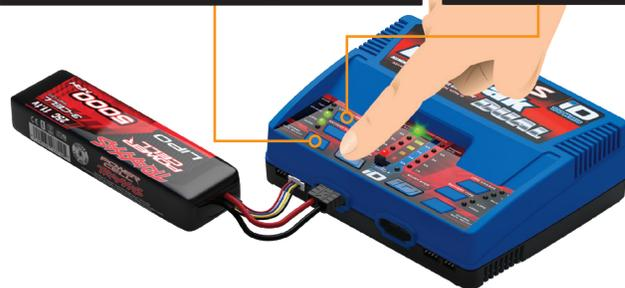
Mantenga presionado el botón Inicio por un segundo. El cargador emitirá un tono, lo que indica que ha iniciado la carga. Presione una vez para detener. El cargador emitirá un tono, lo que indica que se ha cancelado la carga. Los ledes de progreso de carga se encenderán mientras se cargue la batería.
