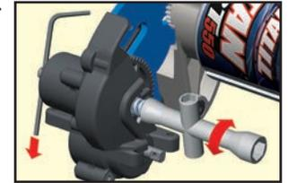
Para ajustar el embrague antirrebote, retire la cubierta de la caja del receptor. Luego, retire el tornillo hexagonal grande único con una llave de 2.5 mm (incluidas). Luego, gire el motor y la estructura hacia el lado del modelo. El embrague antirrebote está incorporado dentro del engranaje cilíndrico principal en la transmisión.
