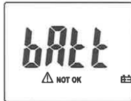
Abb. 2: Anzeige für niedrigen Batterieladezustand
