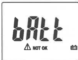
Fig. 2: Indicazione batteria scarica
