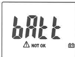
Fig. 2: Indicación pila descargada
