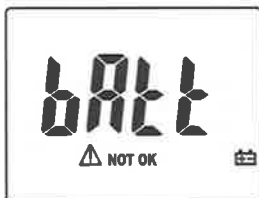
Fig. 2: Indication batterie déchargée
