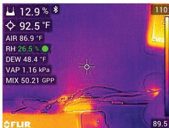
**Abbildung 7.8** IGM™-Benutzermodus mit Feuchtigkeitssmesswert links oben und Psychrometrie direkt darunter
