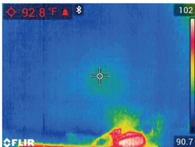
**Abbildung 8.4** Beispiel für einen Alarm bei hohen radiometrischen Werten. Beachten Sie, dass der Messwert rot ist
