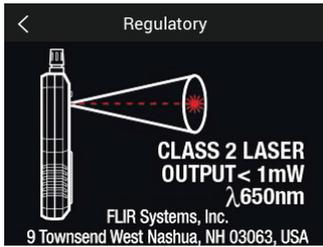
**Abbildung 5.36** Anzeigen von Sicherheitsinformationen für den Laserpointer
