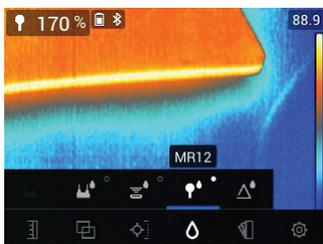
Abbildung 5.20 Auswahl des MR12-Modus (optionaler Feuchtesensor)
