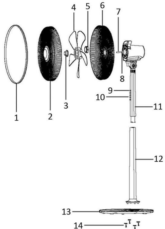
**MONTAGEANWEISUNGEN****Bodenplatte und Schaft montieren**
