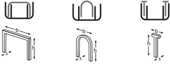
Sie können drei unterschiedliche Klammer-/Nägeltypen in das Gerät einlegen. Beachten Sie zum richtigen Einlegen der Klammer-/Nägeltypen die linke Abbildung.
