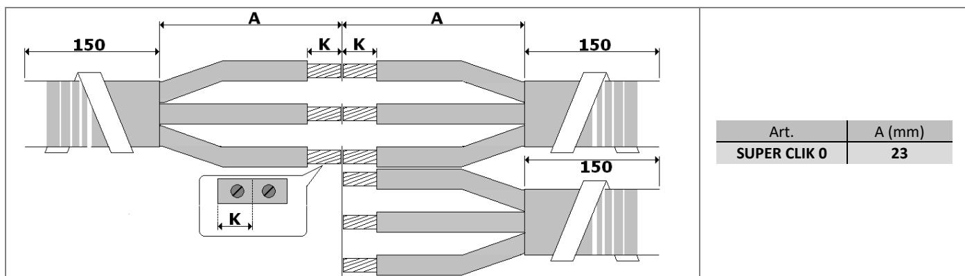
**2. PREPARAZIONE DELLA GIUNZIONE CON CONNETTORI A VITE – JOINT PREPARATION WITH SCREW CONNECTORS -
