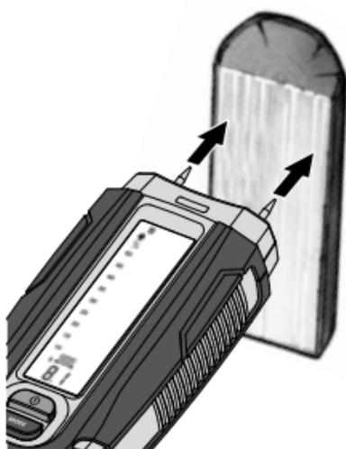
A mérendő helynek kezeletlennek, és ágaktól, kosztól vagy gyantától mentesnek kell lennie. Ne végezzen méréseket a homloklfelületeken, mivel a fa itt különösen gyorsan szárad, és így a mérés hamis eredményt adhat. **Végezzen több összehasonlító mérést az ereszre merőlegesen.**
