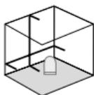
Зняти систему блокування, вимикач (3) перевести в крайнє ліве положення. З'явиться лазерне перехрестя.
