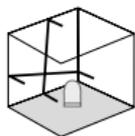
Převodní pojistku neuvolňujte, posuvný vypínač (3) posuňte doprava. Laser zapněte tlačítkem ZAP/VYP. Nyní je možné zalícit šikmé roviny. V tomto režimu není možné provádět horizontální resp. vertikální nivelaci, protože linie laseru se již automaticky nevyrovnávají. LED dioda (1) a laserové linky blikají zeleně.
