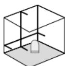
Otpustiti transportni zatvarač, postaviti klizna sklopka (3). Pojavit će se laserski križ.
