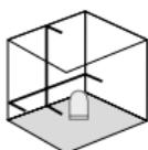
Освободете транспортното укрепване, поставете плъзгачия превключвател (3) в ляво положение. Появява се лазерният кръст.
