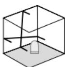
Prepravnú poistku neuvolnite, posuvný vypínač (3) posuňte doprava. Laser zapnite tlačidlom ZAP/VYP. Teraz môžu byť vytvorené šikmé roviny. V tomto režime nie je možná horizontálna, resp. vertikálna nivelácia, pretože laserové línie sa už automaticky nenasmerujú. LED dióda (1) a laserové čiar blikajú na zeleno.
