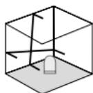
Ne oldja ki a szállítási biztosítót, és tolja a (3) tolókapcsolót jobbra. Kapcsolja be a lézereket a BE/KI nyomógombbal. Ekkor ferde síkok hozhatók létre. Ebben az üzemmódban nem végezhető vízszintes, ill. függőleges szintezés, mivel a lézervonalak beállítása már nem történik meg automatikusan. A LED (1) és a lézervonalak zölden villognak.
