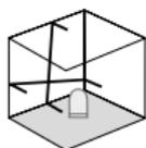
Nu slăbiți șuruburile pentru transport, poziționați comutatorul glisant (3) spre dreapta. Laserul se operează prin tasta PORNIRE/OPRIRE. Acum se pot marca suprafețele înclinate. În acest mod nu se poate nivela în plan orizontal resp. vertical, pentru că razele laser liniare nu se mai ajustează automat. LEDul (1) și liniile laser luminează verde intermitent.
