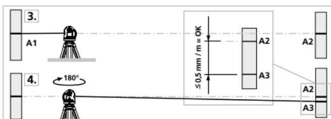
**!** Pokud jsou body A2 a A3 od sebe vzdáleny více než  $0,5 \text{ mm} / \text{m}$ , je nutné provést kalibraci. Spojte se s Vaším specializovaným prodejcem nebo využijte servisního oddělení společnosti UMAREX-LASERLINER.
