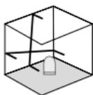
Під час транспортування не знімати блокуючий елемент, вимикач (3) перевести в праве положення. Увімкнути лазер за допомогою кнопки УВІМК/ВИМК. Тепер можна будувати похилі площини. У цьому режимі не можна здійснити горизонтальне або вертикальне нівелювання, тому що лазерні лінії вже автоматично не вирівнюються. Блимають зелений світлодіод (1) і зелені лазерні лінії.
