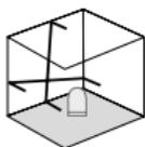
Не освобождавайте транспортната блокировка, преместете плъзгача (3) надясно. Изключете лазера с бутона ВКЛ./ИЗКЛ. Сега може да се зададат наклонени равнини. В този режим не може да се нивелира хоризонтално, съответно вертикално, тъй като лазерните линии вече не се насочват автоматично. Светодиодът (1) и лазерните линии мигат в зелен цвят.
