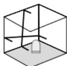
Не отпуская фиксатор для транспортировки, передвинуть ползунковый переключатель (3) вправо. Подключить лазеры с помощью кнопки ВКЛ/ВЫКЛ. Теперь можно получать наклонные поверхности. В этом режиме невозможно горизонтальное или вертикальное нивелирование, так как лазерные линии больше не центрируются автоматически. Светодиоды (1) и лазерные лучи мигают зеленым цветом.
