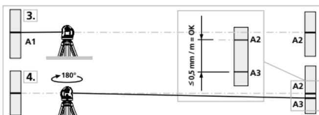
**!** Dacă A2 și A3 se află la o distanță mai mare de 0,5 mm / m, trebuie efectuată o ajustare. Contactați un comerciant specializat și adresați-vă departamentului service UMAREX-LASERLINER.
