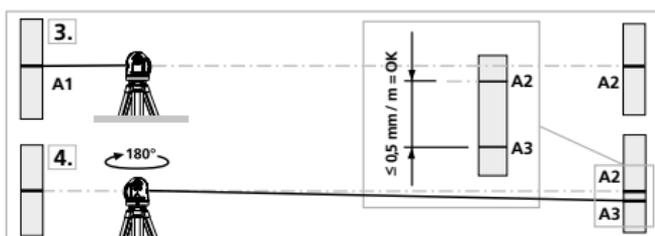
**!** Če sta A2 in A3 več kot 0,5 mm / m narazen, je treba napravo umeriti. Stopite v stik s prodajalcem ali pa se obrnite na servisni oddelek podjetja UMAREX-LASERLINER.
