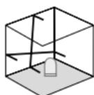
Ne otpuštati transportni zatvarač, postaviti sklopku Klizna sklopka (3). Odabrati i uključiti laser tipkom za odabir. Sada se mogu mjeriti kose ravnine. Ovaj način rada se ne može koristiti za obavljanje horizontalnog ili vertikalnog niveliranja jer se laserske linije više ne poravnavaju automatski. LED (1) i laserske linije trepću zeleno.
