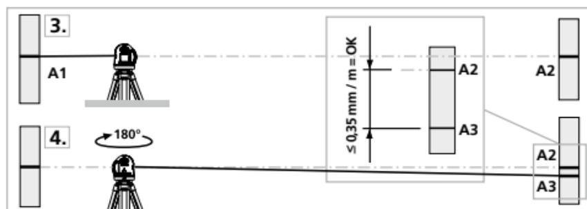
**!** Pokud jsou body A2 a A3 od sebe vzdáleny více než  $0,35 \text{ mm / m}$ , je nutné provést kalibraci. Spojte se s Vaším specializovaným prodejcem nebo využijte servisního oddělení společnosti UMAREX-LASERLINER.
