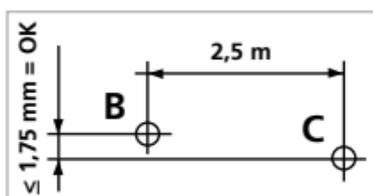
Zkontrolujte, jestli vodorovná čára od bodu C leží  $\pm 1,75$  mm ve stejné výšce s bodem B. Postup opakujte natočením doleva.
