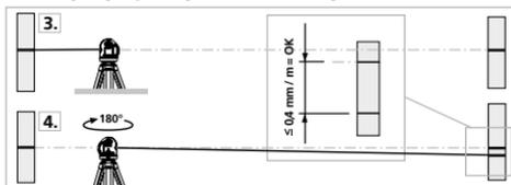
3. Postaviti uređaj što je bliže moguće zidu na visini točke A1.
