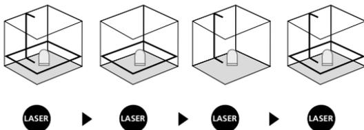
! Pentru nivelarea orizontală și verticală, siguranța pentru transport trebuie să fie îndepărtată. LED-ul luminează constant verde. De îndată ce aparatul se află în afara domeniului de nivelare automată de 5°, razele laser pâlpâie iar LED-ul luminează roșu. Poziționați aparatul astfel încât acesta să se afle în cadrul domeniului de nivelare. LED-ul e aprinde din nou verde iar razele laser luminează constant.
