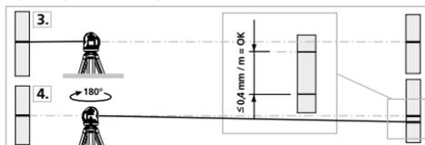
3. Поставьте прибор как можно ближе к стене на высоте точки A1. Отрегулируйте прибор.
