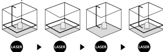
! Для горизонтального и вертикального нивелирования необходимо снять с блокировки фиксатор для транспортировки. Постоянно горит зеленый светодиод. Как только прибор окажется за пределами автоматического диапазона нивелирования, равного 5°, лазерные линии и светодиод начинают гореть красным цветом. Позиционировать прибор так, чтобы он находился в пределах диапазона нивелирования. Светодиод снова изменяет свой цвет на зеленый, а лазерные линии светятся постоянно.
