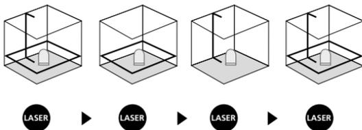
Для горизонтального і вертикального нівелювання необхідно розфіксувати транспортне стопоріння. Постійно світиться зелений світлодіод. У разі виходу за межі діапазону автоматичного нівелювання, що становить 5°, лазерні лінії починають блимати, а світлодіодний індикатор загоряється червоним світлом. Розташуйте прилад так, щоб він потрапив у межі діапазону автоматичного нівелювання. Світлодіод знову змінить колір на зелений, а лазерні лінії загоряться сталим світлом.
