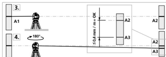
! Jos A2 ja A3 ovat toisistaan etäämmällä kuin  $0,4 \text{ mm / m}$ , on säätö tarpeen. Ota yhteys paikalliseen laitetoimittajaan tai UMAREX-LASERLINER huolto-osastoon.
