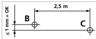
Сделайте отметку С. Расстояние между горизонтальными линиями, проведенными через эти две точки, не должно превышать  $\pm 1$  мм. Повторите замеры, поворачивая прибор влево.
