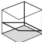
Taşıma emniyetini çözmemeyin, sürmeli şalteri (2) sağ tarafa çekin ve lazeri 7 tuşuya açın. Şimdi eğimli düzlemler ve de eğimler ayarlanabilir. Bu modda lazer ışını artık otomatik olarak hizalanmamaktadır. Bu durum lazer ışının yanıp sönmesi ile bildirilir.
