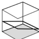
Ne sprostite transportnega varovala, drsno stikalo (2) potisnite v desno in laser vključite s tipko 7. Sedaj lahko izravnavate pošechnve oz. nagnjene površine. V tem načinu se laserska linija več ne poravna samodejno. To je signalizirano z utripanjem laserske linije.
