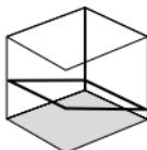
Nu desfaceți siguranța de transport, glisați întrerupătorul glisant (2) spre dreapta și porniți laserul cu tasta 7. Acum se pot marca suprafetele înclinate, resp. înclinațiile. În acest mod linia laser nu se mai aliniază automat. Acest lucru este semnalizat prin pâlpâirea liniei laser.
