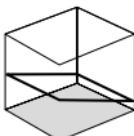
Не освобождавайте работното осигуряване, избутайте плъзгащия превключвател (2) надясно и включете лазера с бутона 7. Сега може да се създадат наклонени равнини, сътв. наклони. В този режим лазерната линия не се подравнява автоматично. Това се сигнализира чрез мигане на лазерната линия.
