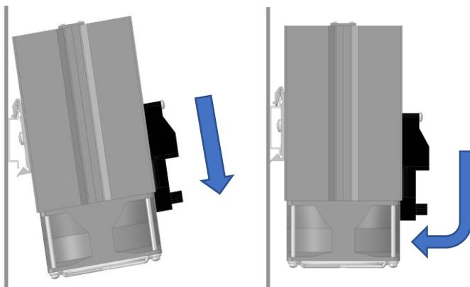
Um eine optimale Luftzirkulation zu erreichen, sollte die Heizung senkrecht im unteren Bereich des Schaltschranks mit dem Anschluss / Lüfter nach unten (Ausblasrichtung nach oben), oder zur Seite montiert werden. Die Heizung kann über eine Halteklammer (35mm-Tragschiene nach DIN EN 50 022) montiert werden.
