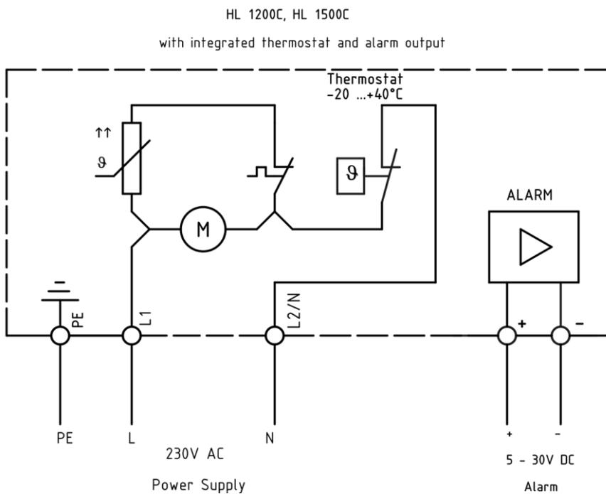
HL 1200C und HL 1500C besitzen ein integriertes elektronisches Thermostat mit Alarmausgang für den Fall eines Lüfterdefekts (5-30 V DC / 0,5A)
