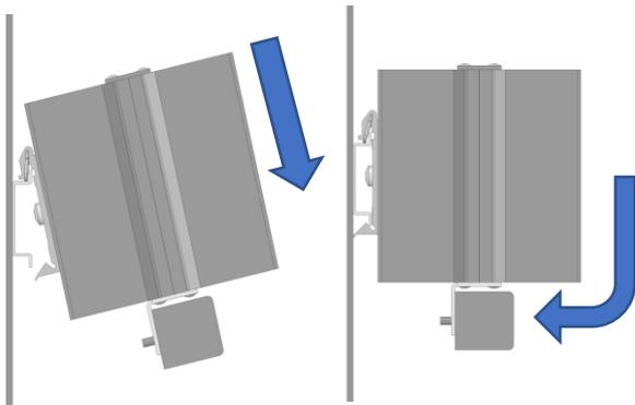
Um eine optimale Luftzirkulation zu erreichen, sollte die Heizung senkrecht im unteren Bereich des Schaltschranks mit dem Anschluss nach unten eingesetzt werden. Die Heizung kann über eine Halteklammer (35mm-Tragschiene nach DIN EN 50 022) montiert werden.
