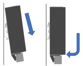
Um eine optimale Luftzirkulation zu erreichen, sollte die Heizung senkrecht im unteren Bereich des Schaltschranks mit dem Anschluss nach unten eingesetzt werden. Die Heizung kann über eine Halteklammer (35mm-Tragschiene nach DIN EN 50 022) montiert werden.
