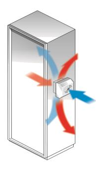
Optimale Kühlung: Die warme Luft wird im Schaltschrank abgesaugt, im Kühlgerät abgekühlt und dann mit hoher Geschwindigkeit wieder in den Schrank geleitet. Auf diese Weise wird eine optimale und gleichmäßige Kühlung im gesamten Schaltschrank erreicht.
