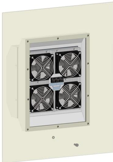
Ansicht von innen: das Kühlgerät mit zehn Sechskantschrauben M6x16 mit Unterlegscheibe befestigen (7 Nm)
