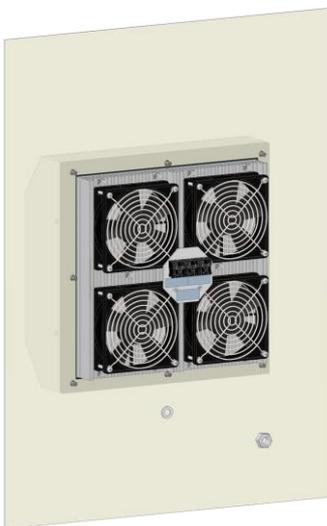
Ansicht von innen: das Kühlgerät mit acht selbstsichernden Muttern M6 mit Unterlegscheiben befestigen (7 Nm)
