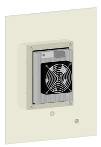
Ansicht von innen: das Kühlgerät mit vier selbstsichernden Muttern M6 mit Unterlegscheiben befestigen (7 Nm)
