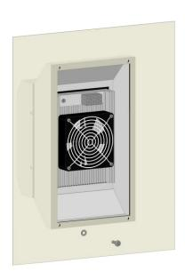
Ansicht von innen: das Kühlgerät mit vier Linsenkopfschrauben M5x16 mit Unterlegscheibe befestigen (5 Nm)
